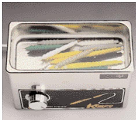
**Abb. 13.2.3** Ultraschall-Reiniger: in 15 Minuten werden die Elektrodenstifte und die dazugehörigen Kabel gereinigt.
